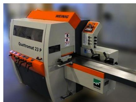
Figure 13. Corroyeuse moulurière - Source : Weining
