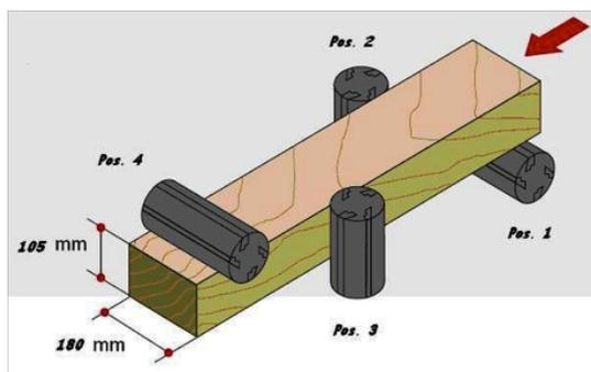
Figure 12. Schéma de corroyeuse
