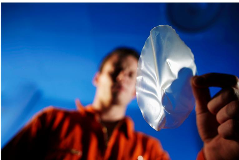
**Figure 9. Microfibrilles de cellulose (films souples) - Source CTP**
