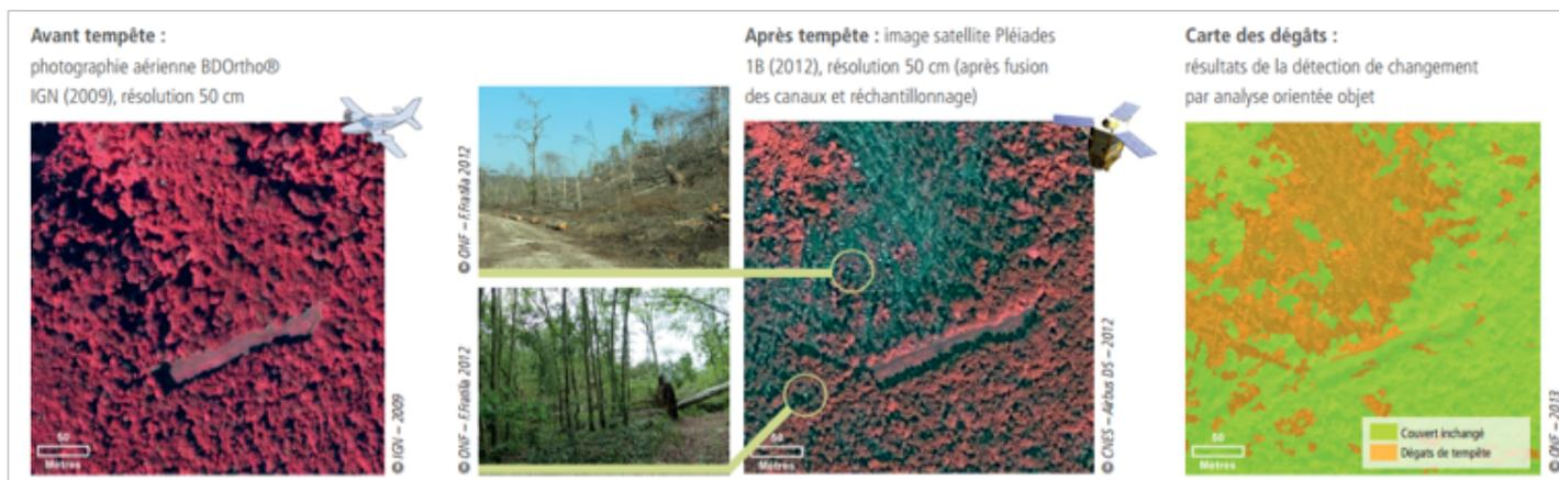
**Figure 4. Détection de dégâts de tempête à partir de la comparaison entre une photographie aérienne avant tempête (BDOrtho® IGN) et une image Pléiades après tempête.** Contient des informations © CNES – 2014 – distribution Airbus DS / France – tous droits réservés.
