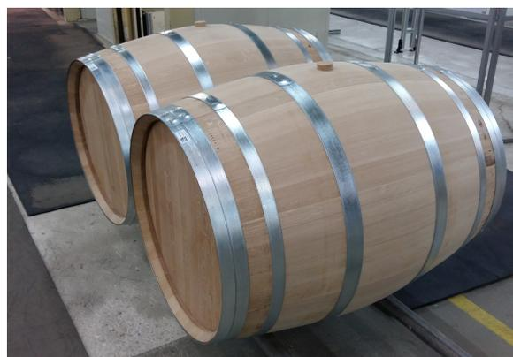
**Figure 4. Barriques en fin de montage** Photo Taransaud
