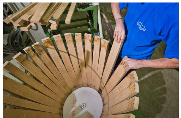
**Figure 2. Mise en robe d'un fût pour le cintrage** Photo Taransaud
